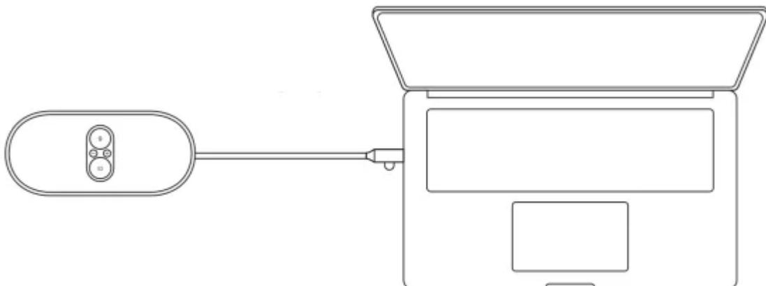
Standard Betrieb am USB-C Anschluß (muss Video-fähig sein)
