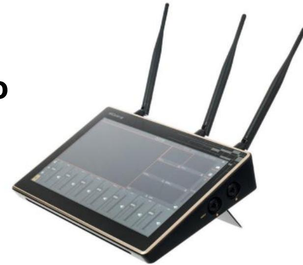
bis zu 6 Videosignale in unterschiedlichen Auflösungen (2x SDI, 2x HDMI, 1x Netzwerk und 1x interner Speicher) können gleichzeitig verbunden werden
